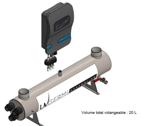
Dans la chambre de traitement, les lampes UV sont placées dans des gaines en quartz. Cette réalisation permet d'éviter le refroidissement des lampes par le passage de l'eau, car leur efficacité maximale est à 40°C. La couche d'air entre les gaines et les lampes suffit pour maintenir cette température : les gaines de quartz servent de séparation entre les lampes et le liquide comme isolation électrique et thermique.
